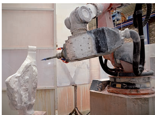
Le robot 6 axes Agut, installé dans l'atelier de marbrerie de Marbres de France à Saint-Pons, a notamment permis la fabrication du guéridon ajouré.
